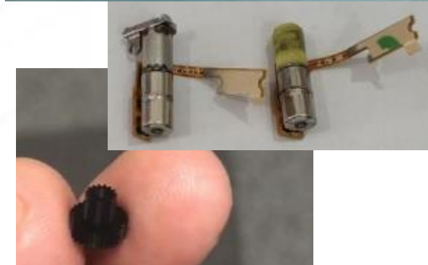
Mechanismus einer Handykamera
