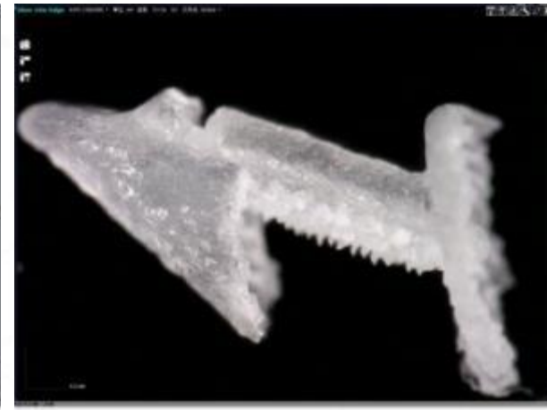
SLA XY Druckauflösung: 50 µm
