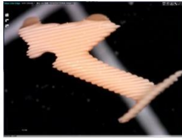
DLP XY Druckauflösung: 35 µm
